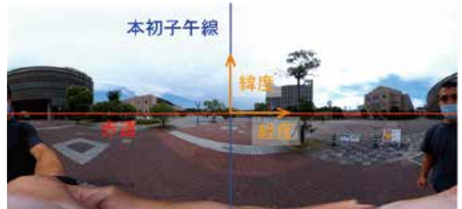
正距円筒図法を用いて展開した画像と天球における緯度・経度の関係
