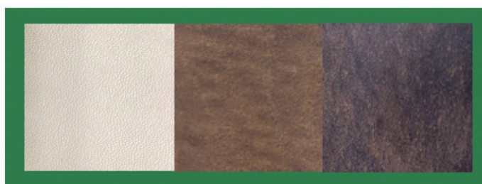
グルコース酸化物で着色した牛革（左：着色前、中：淡色、右：濃色）
